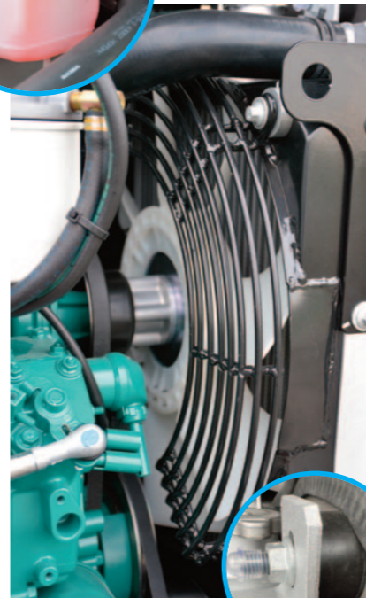
Vaso d'espansione del liquido refrigerante ben visibile e in posizione più alta dei radiatori. Perfetto.
