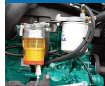
Spurgo gasolio e reinnescio elettrico di serie
